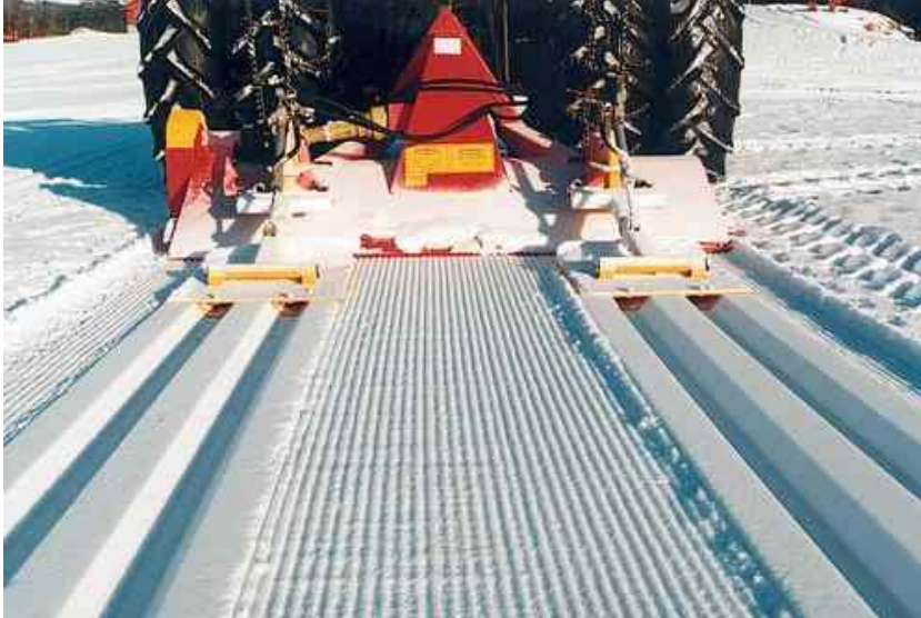
Bild 7. Norgesfräsen med dubbla spåraggregat dragen efter en traktor.
