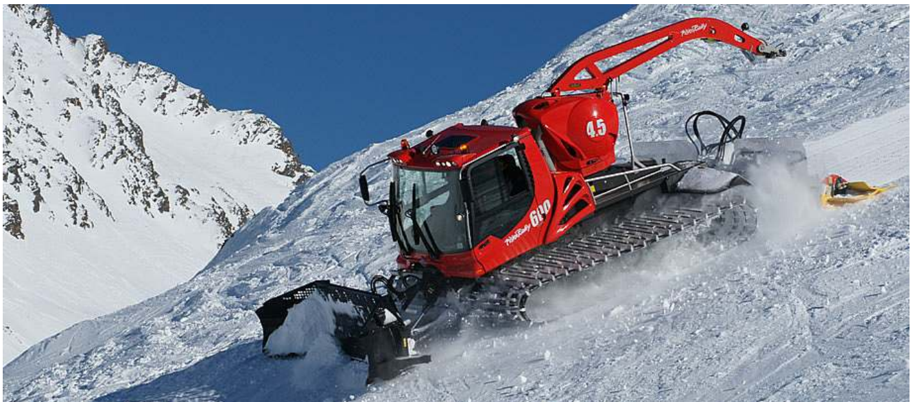
Bild 6. Pistmaskin Pisten Bully utrustad med winch för att kunna dra sig upp t ex hoppbackar.
