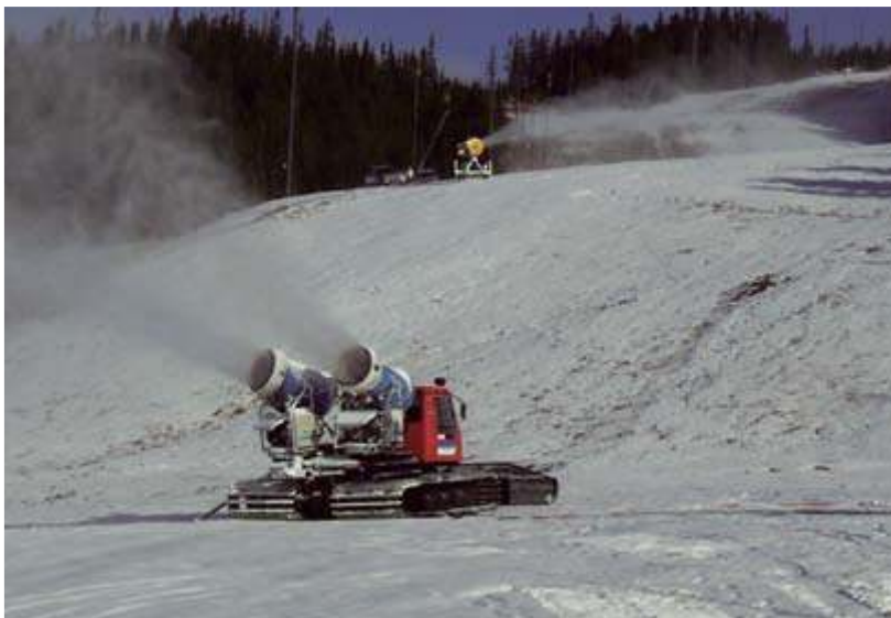
Bild 10. Snökanoner monterade på pistmaskin för ökad rörlighet.
