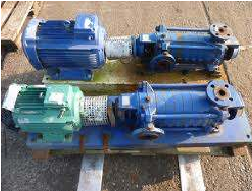
Bild 11. Två pumpar KSB Movi 32/7 färdiga för pension efter väl utfört arbete.
